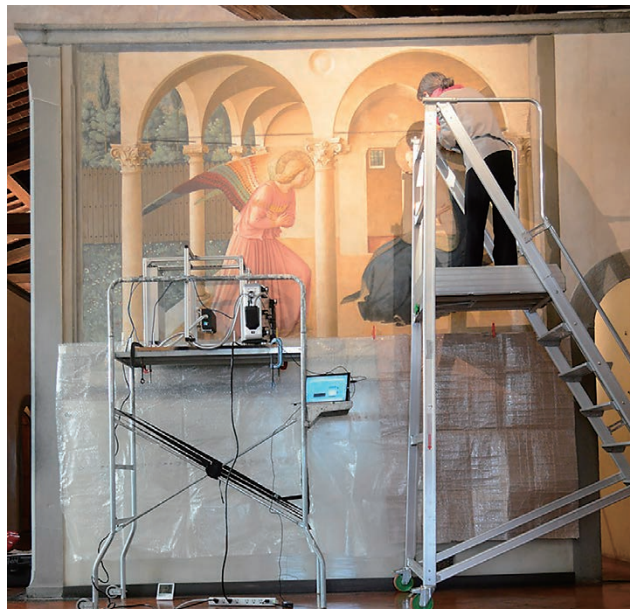
図2 電磁波を用いた科学調査中の様子。壁画下方に衝突防止用ガラス板があり、そこにエアキャップを掛けている。左中央の自動計測中の装置は、パイオニア(株)製のテラヘルツ波イメージャー。右上がハンディタイプの蛍光X線装置で元素分析中の筆者
