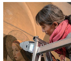
図2 電磁波を用いた科学調査中の様子。壁画下方に衝突防止用ガラス板があり、そこにエアキャップを掛けている。左中央の自動計測中の装置は、パイオニア(株)製のテラヘルツ波イメージャー。右上がハンディタイプの蛍光X線装置で元素分析中の筆者
