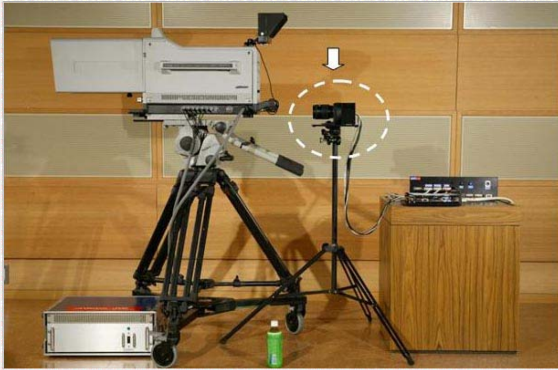
図1 従来の800万画素超高精細CMOS動画像カメラ（左）と 今回開発した小型カメラシステム（右）の大きさ比較
