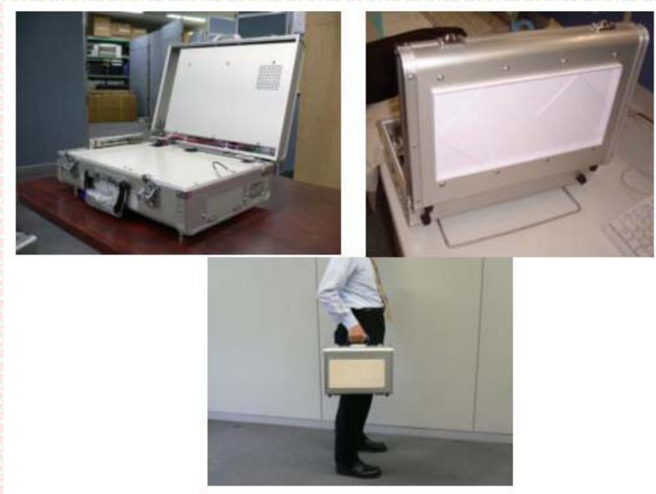
図1 小型ポータブル32GHz帯ミリ波無線ターミナルの外観 (サイズ: 392.5 × 140 × 275 mm、突起物を含まず)、 ノートPC等を直接接続して使用
