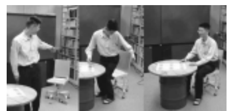
図3 動く椅子 ジェスチャーによって呼び寄せると、適切な位置・姿勢に寄って来て座ることができる。
