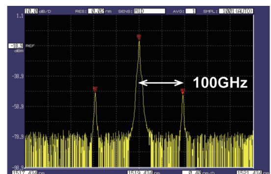
図 1 100 GHz 光位相変調動作の確認 (※光通信基盤研究室で測定)
